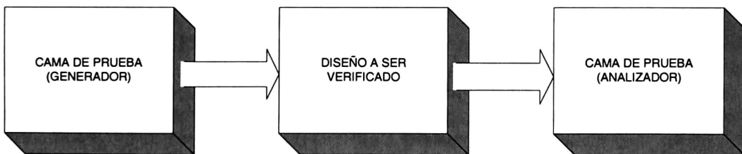
Figura 1. Estructura genérica de una cama de pruebas y un diseño bajo prueba.
