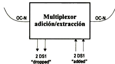
Figura 2.4. Multiplexor de adición/extracción (Add/Drop)
